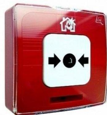
Извещатель пожарный ручной осуществляет формирование сигнала на включение различных инженерных систем при нажатии на кнопку. Снятие сигнала осуществляется возвратом кнопки в исходное положение с использованием штыря диаметром не более 3 мм. Устройство дистанционного пуска состоит из основания и корпуса. На основании установлена плата с радиоэлементами и клеммником для подключения проводов ШС.
